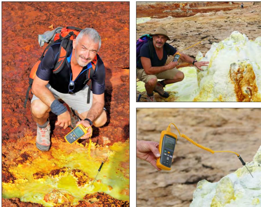
Figure 10, 11, 12. Le temperature delle fumarole e delle salamoie iperacide ( $pH \leq 0$ ) presentano temperatura dai  $100^\circ$  ai  $110^\circ C$  con temperature massime di  $125/130^\circ C$
